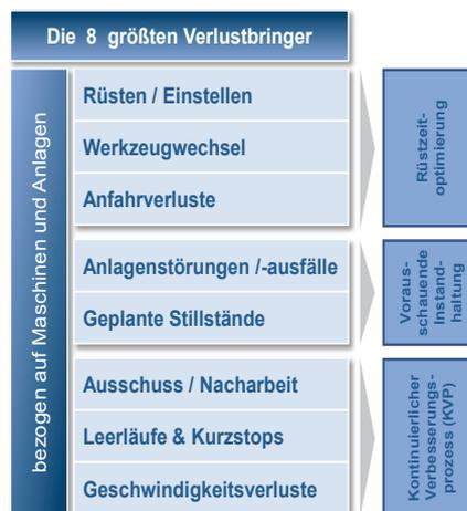
Ein aussagekräftiges Kennzahlensystem hilft bei der Identifikation von Verschwendung, da viele Unternehmen das Bewusstsein für chronische Verluste bereits verloren haben. Mit Hilfe geeigneter Methoden, wie z.B. Rüstzeitoptimierung, vorausschauender Instandhaltung oder dem kontinuierlichen Verbesserungsprozess (KVP), lassen sich diese Arten von Verschwendung eliminieren.
